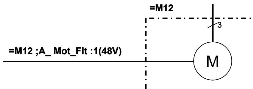
Figure 21 – Exemple de désignation d'un signal correspondant à la classe de conformité 2
